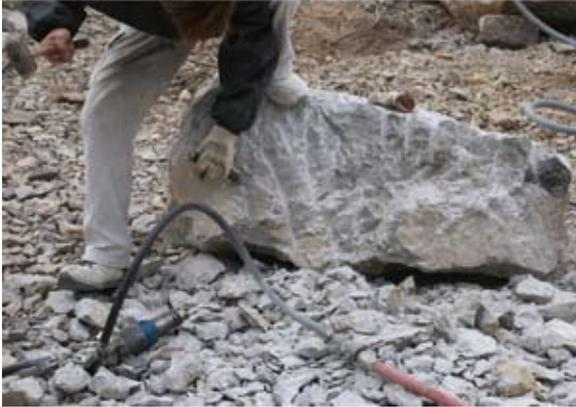
鉄門の築石など、形を整える必要のある石材は、手作業によるノミ加工が丁寧に施される
